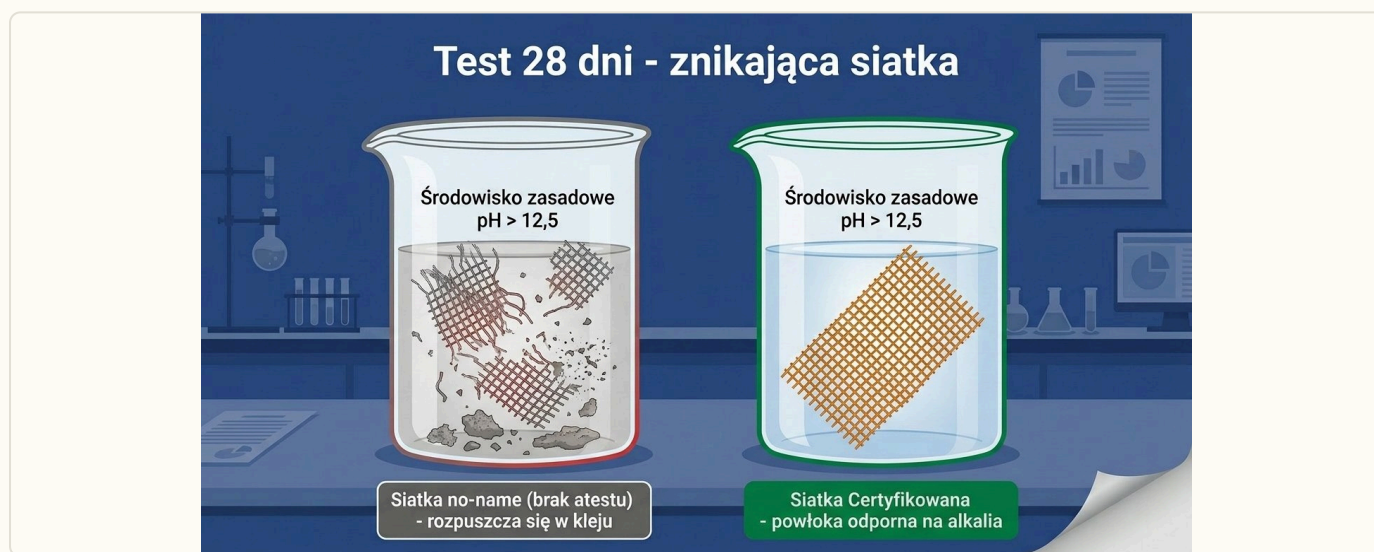
Rys. 1. Test 28 dni w środowisku zasadowym (pH > 12,5) — siatka no-name vs. siatka certyfikowana z powłoką odporną na alkalia
